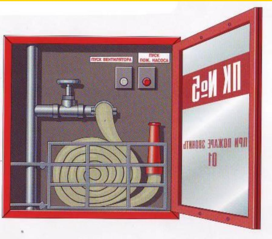
Предназначен для тушения пожаров водой от внутреннего противопожарного водопровода в жилых, административных и производственных помещениях
