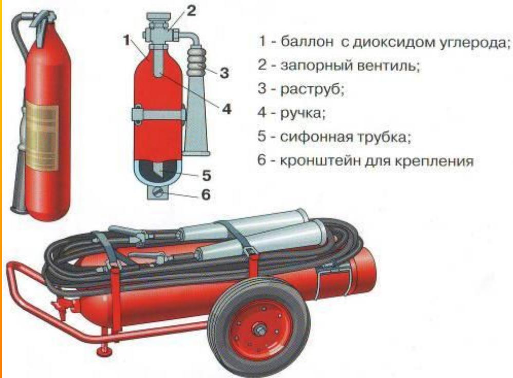
Используют при загораниях на электроустановках под напряжением до 1000 В, при пожарах в музеях, архивах
