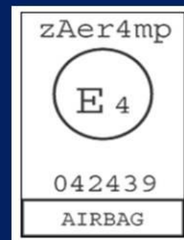
Дополнительный признак боковых подушек безопасности в сиденьях — обозначение на ярлыке, пришитом к ленте ремней безопасности
