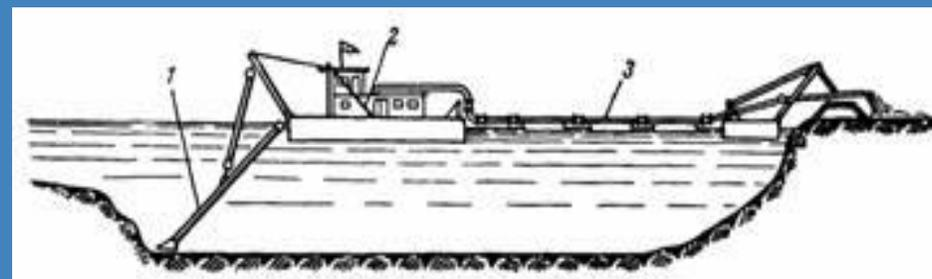
Рис 2. Схема землесосных работ.
