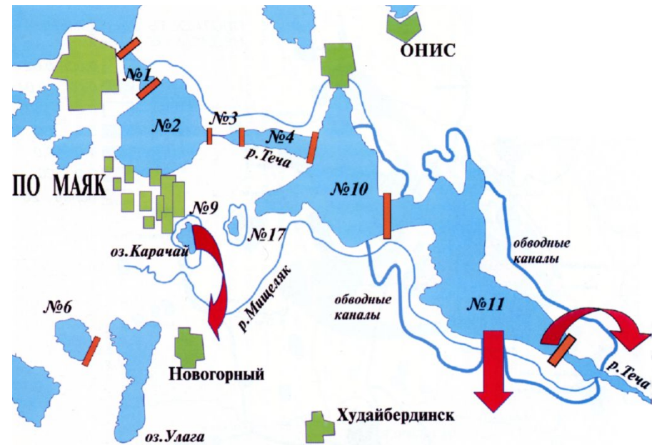
Каскад водоемов-отстойников ПО «Маяк».
