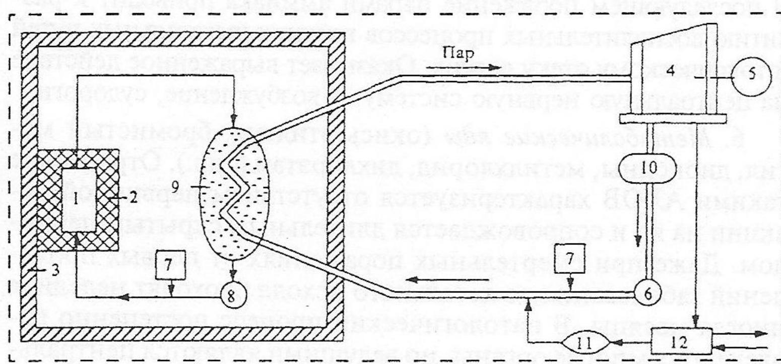
1- реактор, 2 – первичная биологическая защита, 3 – вторичная биологическая защита, 4 – турбина, 5 – электрогенератор, 6 – компрессор, 7 – емкость для пополнения теплоносителя, 8 – циркуляционный насос, 9 – парогенератор, 10 – конденсатор, 11 – подогреватель, 12- сетевой теплообменник.
