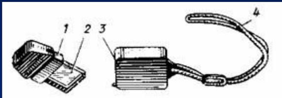
Индивидуальный радиофотолуминесцентный измеритель дозы ИД-11 предназначен для измерения поглощённой дозы суммарного гамма-нейронного излучения в диапазоне от 10 до 1500 рад.
