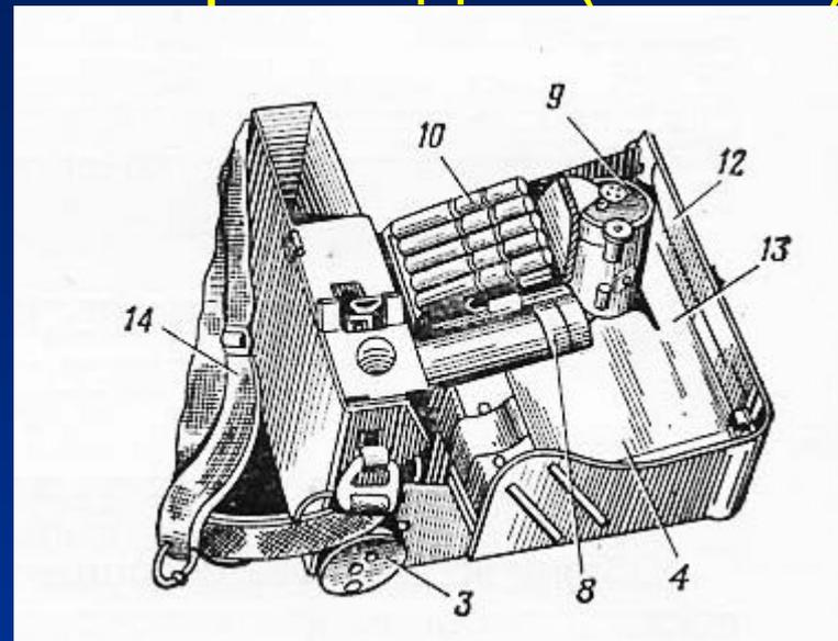
ВПХР: 1 - корпус; 2 - крышка; 3 - ручной насос; 4 - кассеты с индикаторными трубками; 5 - противоярозольные фильтры; 6 - насадка; 7 - защитные колпачки; 8 - электрофонарь; 9 - грелка; 10 - патроны к грелке; 11 - лопатка; 12 - инструкция-памятка по работе с прибором; 13 - инструкция по обнаружению фосфорорганических ОВ; 14 - плечевой ремень.
