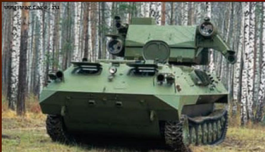
**Предназначен для дистанционного обнаружения зараженности приземного слоя атмосферы аэрозолями отравляющих веществ (ОВ).**
