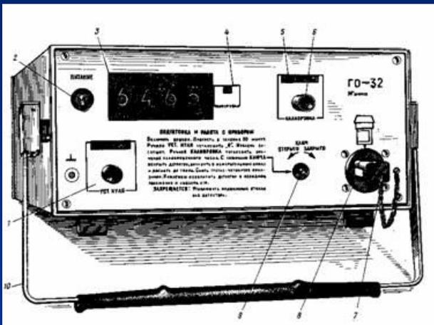
Результат измерений отображается на цифровом табло ГО-32 и представляет собой суммарное значение дозы, набранной измерителем дозы при периодическом (дробном) облучении. Измеритель дозы ИД-11 сохраняет набранную дозу в течение длительного срока (не менее 12 месяцев) и позволяет проводить её многократное измерение.
