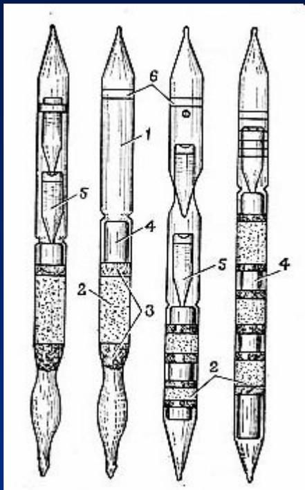
ИНДИКАТОРНЫЕ ТРУБКИ : 1 - корпус трубки; 2 - наполнитель; 3 - ватный тампон; 4 - обтекатель; 5 - ампулы с индикатором; 6 - маркировочное кольцо. ИНДИКАТОРНЫЕ ТРУБКИ, имеющие одинаковую маркировку, укладываются в кассеты по 10 штук. На лицевой стороне кассеты наклеена этикетка с изображением окраски, возникающей на наполнителе трубки при наличии в воздухе ОВ, и указан порядок работы с данной трубкой. В комплект прибора ВПХР входят три комплекта индикаторных трубок.
