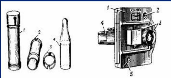
Действие калориметра основано на сравнении окраски раствора в ампуле измерителя с окраской одного из одиннадцати светофильтров, цвету которых соответствует доза 0, 50, 75, 100, 150, 200, 250, 300, 450, 600, 800рад. Отсчет доз производится непосредственно по шкале калориметра в радах.
