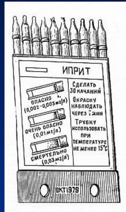
Принцип работы прибора заключается в следующем. При просасывании ручным поршневым насосом зараженного воздуха через индикаторные трубки в них происходит изменение окраски наполнителя под действием ОВ. По изменению окраски наполнителя и её интенсивности или времени перехода окраски судят о наличии ОВ и его примерной концентрации.
