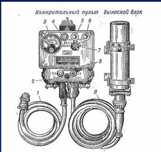
ИЗМЕРИТЕЛЬ мощности дозы ДП-3Б
