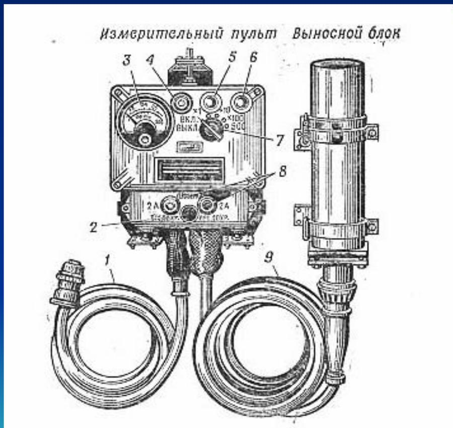
предназначен для измерения мощности экспозиционной дозы гамма-излучения при ведении радиационной разведки с подвижных объектов. В комплект прибора ДП-3Б входят измерительный пульт, блок детектирования, соединительный кабель с прямым и угловым разъёмами, кабель питания, скобы для крепления, комплект ЗИП, техническое описание и формуляр:
