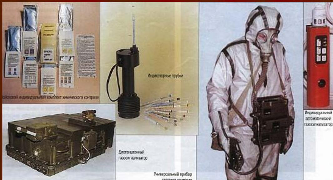
*ИНДИКАТОРНЫЕ ТРУБКИ (ИТ) - самое простое и экономичное средство экспресс-анализа для обнаружения ОВ нервно-паралитического и кожно-нарывного действия, паров КРТ, СДЯВ, для санитарно-химического контроля воздуха на объектах ВМФ - индикаторные трубки типа ИТМ (морские).*
