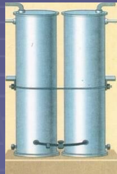
Вертикальный бак аварийного запаса воды
