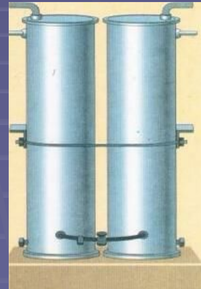
Вертикальный бак аварийного запаса воды
