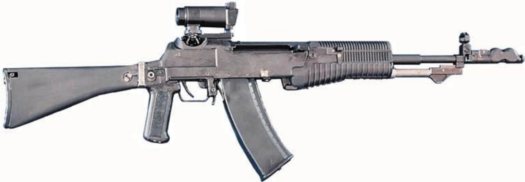
Использование принципа смещенного импульса отдачи, переменного темпа стрельбы и магазина емкостью 60 патронов позволили повысить эффективность стрельбы в 1,5-2 раза, по сравнению с такими распространенными образцами, как АК-74 и M16A2. При стрельбе очередями первые два выстрела делает в темпе 1800 выстр/мин, затем автоматически переходит на 600 выстр/мин.
