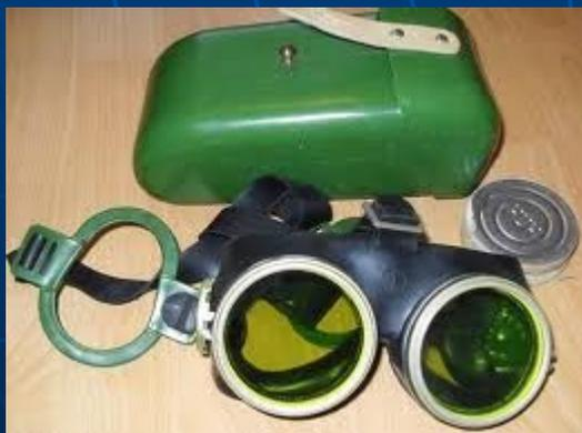
*Защитные очки ОПФ и ОФ по внешнему виду, составу и устройству не отличаются друг от друга. Различие между ними состоит в свойствах фотохромных материалов, применяемых в блоках светофильтров*
