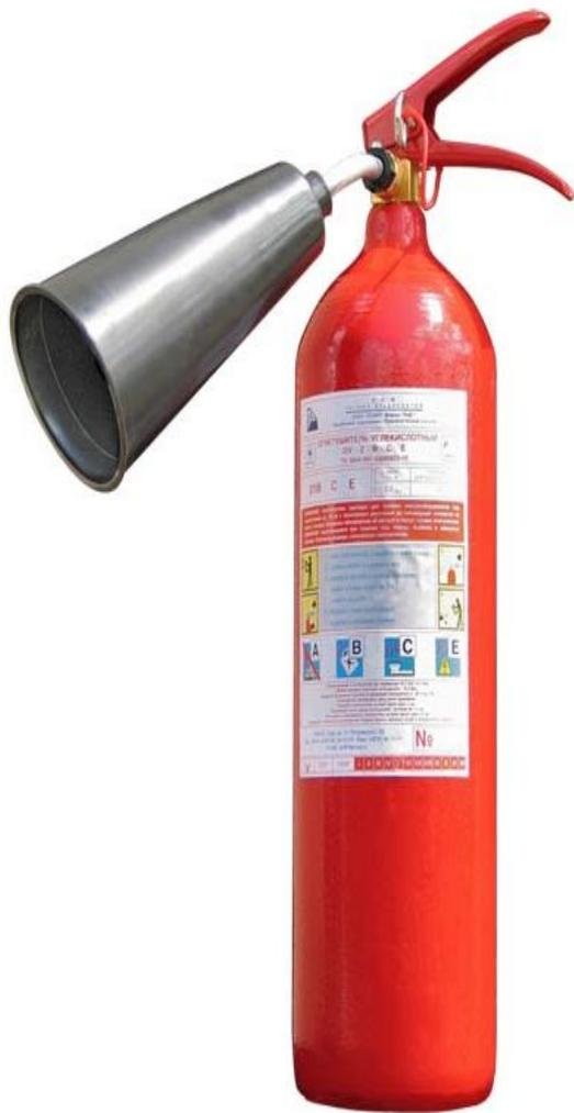
Для приведения в действие углекислотного огнетушителя необходимо направить раструб-снегообразователь на очаг пожара и отвернуть до отказа маховичок или нажать на рычаг запорно-пускового устройства.
