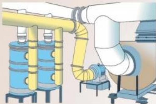
ОБЩИЙ ВИД ВЕНТИЛЯТОРА С ЭЛЕКТРОПРИВОДОМ
