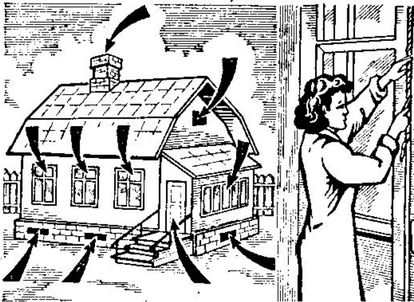
Рис. Места слабой герметизации жилого дома, которые необходимо заделать от проникновения АХОВ
