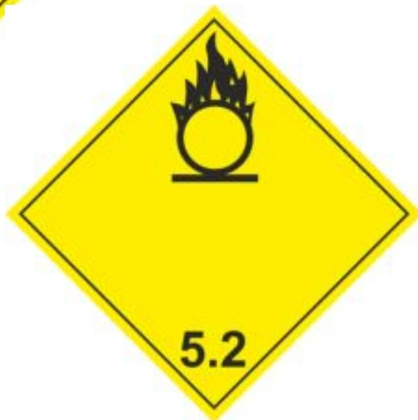
**Класс 5 (окисляющие вещества и органические пероксиды).** Специфичность свойств опасных грузов данного класса определяется их способностью при нагревании:
