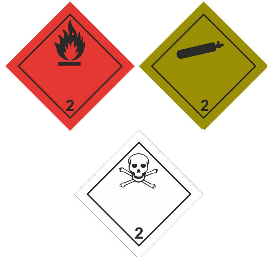
**Класс 2 (газы сжатые, сжиженные и растворенные под давлением).** При проведении восстановительных работ с этими грузами необходимо учитывать, что в емкостях (цистернах, баллонах) имеет место избыточное давление. Цистерны со сжиженными и сжатыми газами необходимо охлаждать независимо от природы газа.
