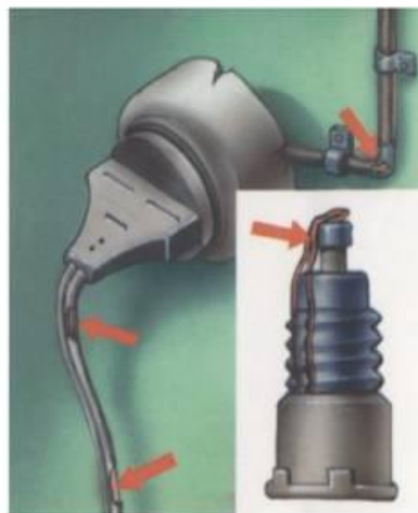
Неисправность электропроводки Пользование самодельными предохранителями
