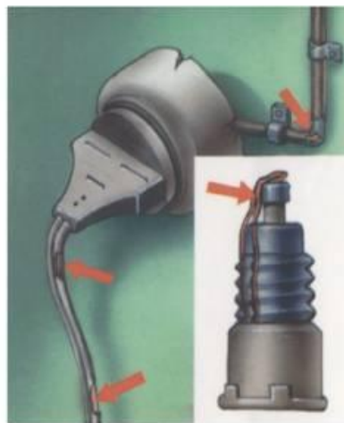
Неисправность электропроводки Пользование самодельными предохранителями
