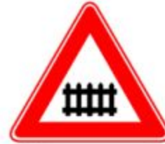
Железнодорожный переезд со шлагбаумом
