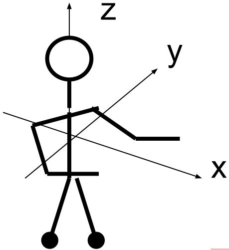
вибрация подразделяется в соответствии с направлением ортогональной системы координат
