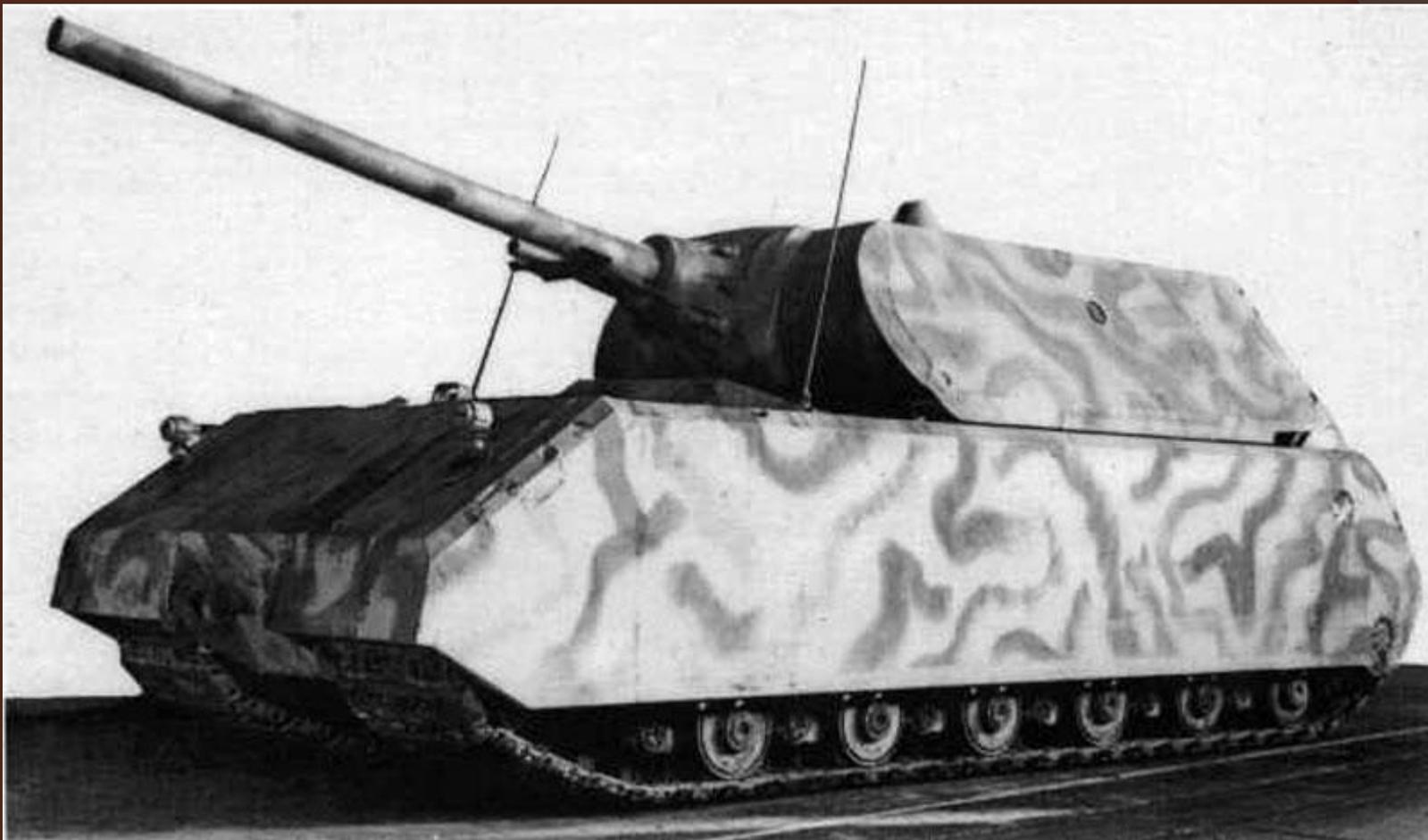
Проектом предусматривалось создание танка с бронированием: лоб корпуса — 200 мм, башни — 220 мм, борт корпуса — 180 мм, борт и корма башни — 200 мм. Боевая масса должна была составлять 160 т, максимальная скорость — 15 км/ч. В первоначальном варианте предусматривалось вооружение в составе 150-мм орудия с длиной ствола в 37 калибров и 105-мм пушки с длиной ствола в 70 калибров.
