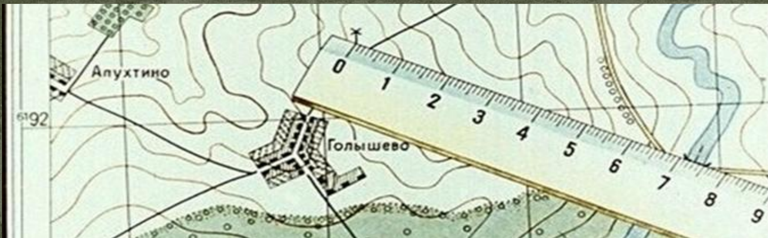
Рис. 2. Определить по карте расстояние между точками местности с помощью линейки
