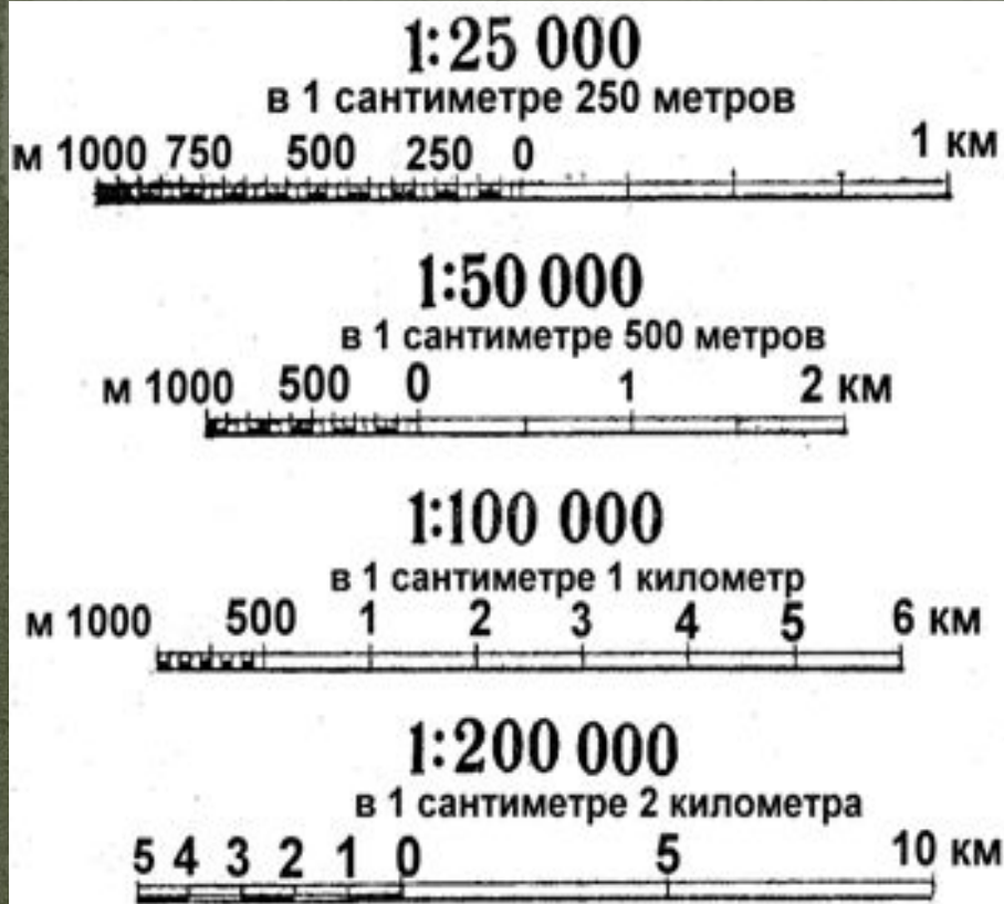
Рис. 1. Оформление численного и линейного масштабов на топографических картах и планах городов
