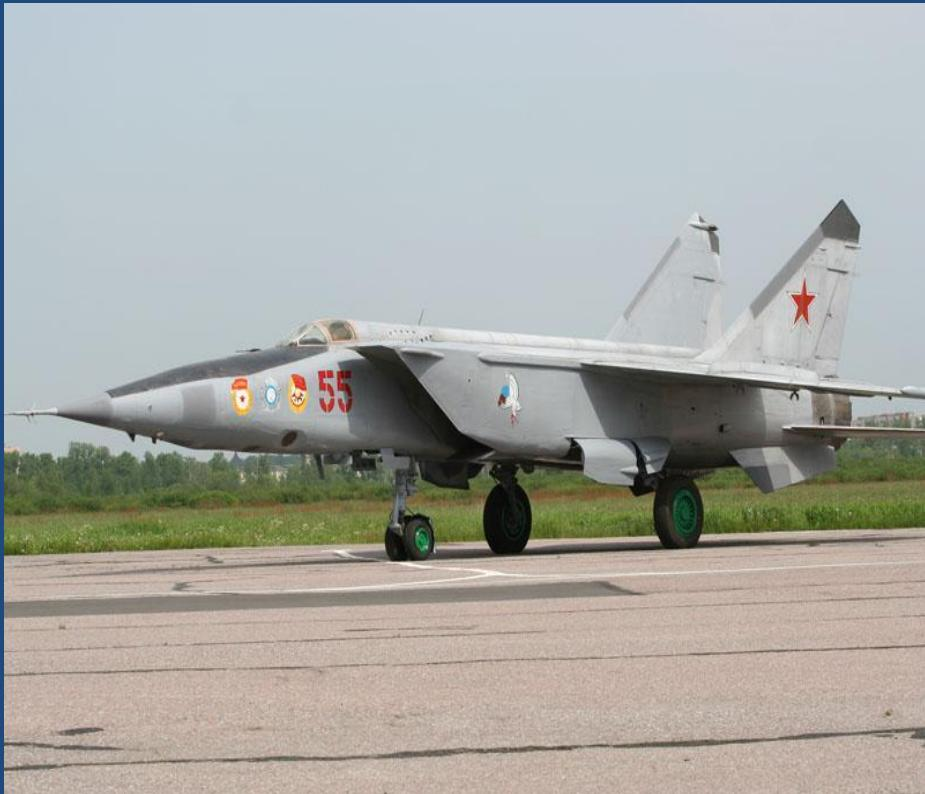
• МиГ-25РБ - одноместный всевысотный самолет оперативной разведки – бомбардировщик. Предназначен для ведения воздушной фото- и радиотехнической разведки и нанесения ударов по площадным наземным целям.
