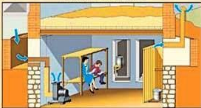
Подвал одноэтажного здания, приспособленный под противорадиационное укрытие
