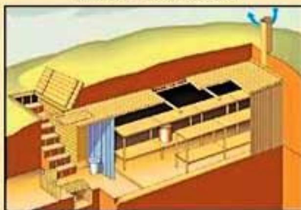
Отдельно стоящее противорадиационное укрытие из лесоматериалов
