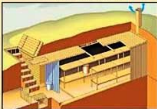
Отдельно стоящее противорадиационное укрытие из лесоматериалов
