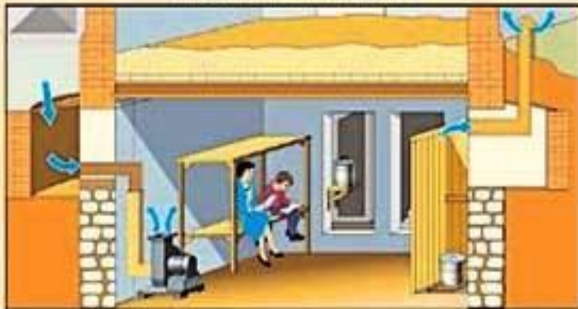
Подвал одноэтажного здания, приспособленный под противорадиационное укрытие
