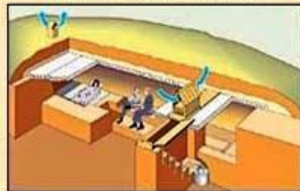
Быстровозводимое противорадиационное укрытие из железобетонных плит
