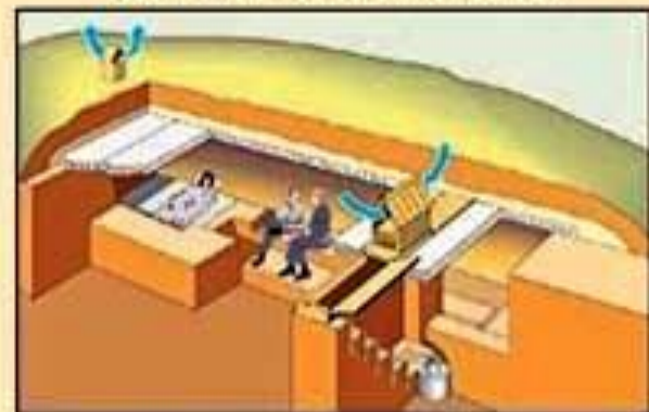
Быстровозводимое противорадиационное укрытие из железобетонных плит
