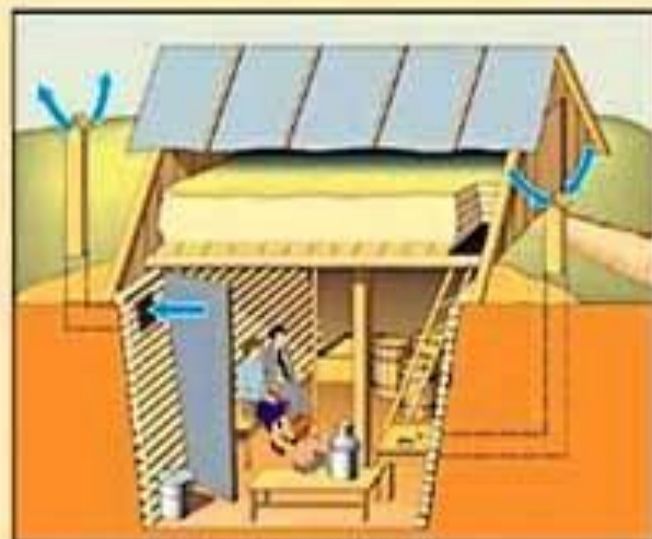
Отдельно стоящее противорадиационное укрытие (логгреб)
