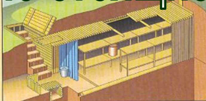
Отдельно стоящее противорадиационное укрытие из лесоматериалов
