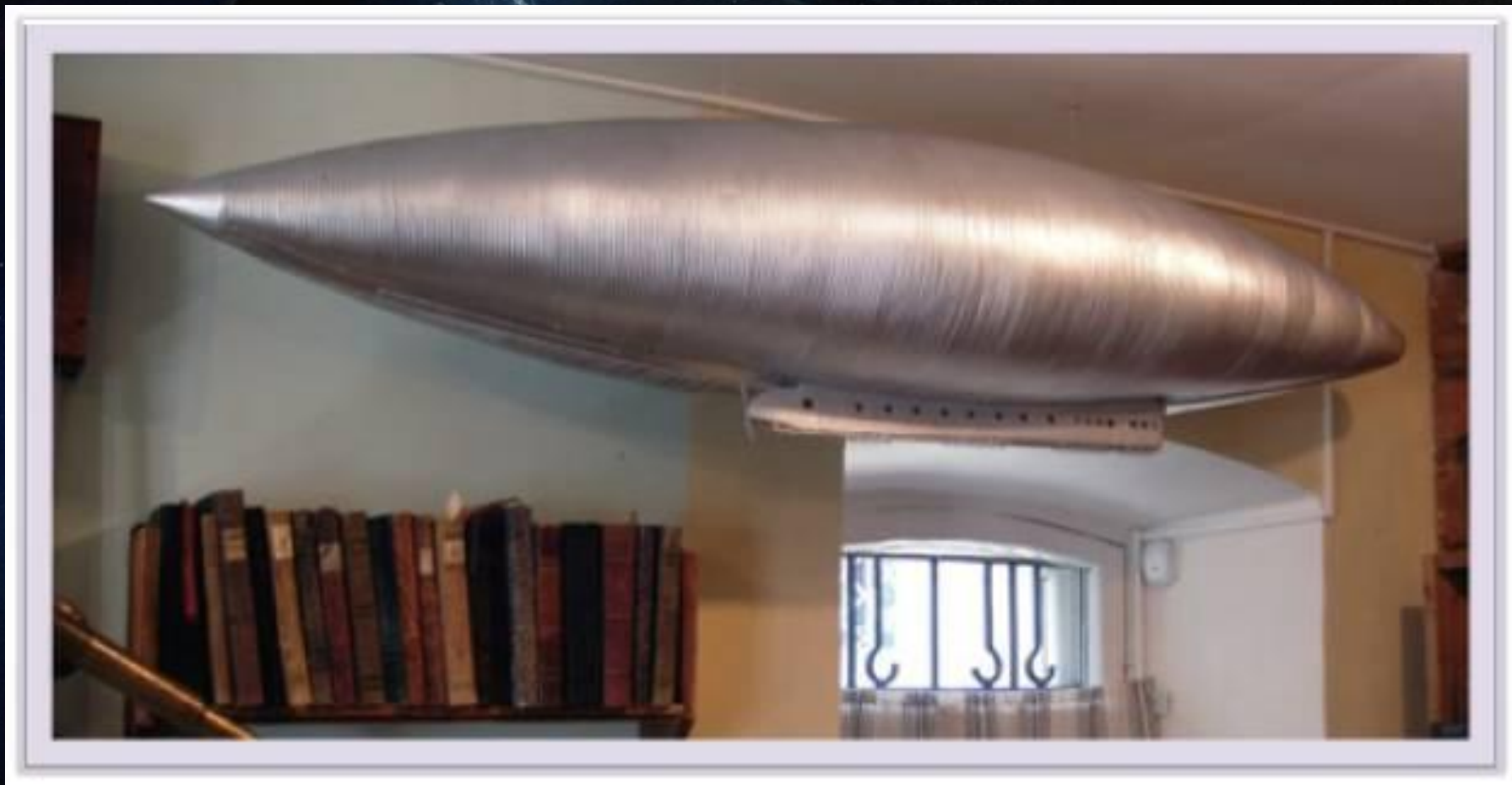
Модель оболочки аэростата из гофрированного металла (дом-музей К. Э. Циолковского в Боровске)
