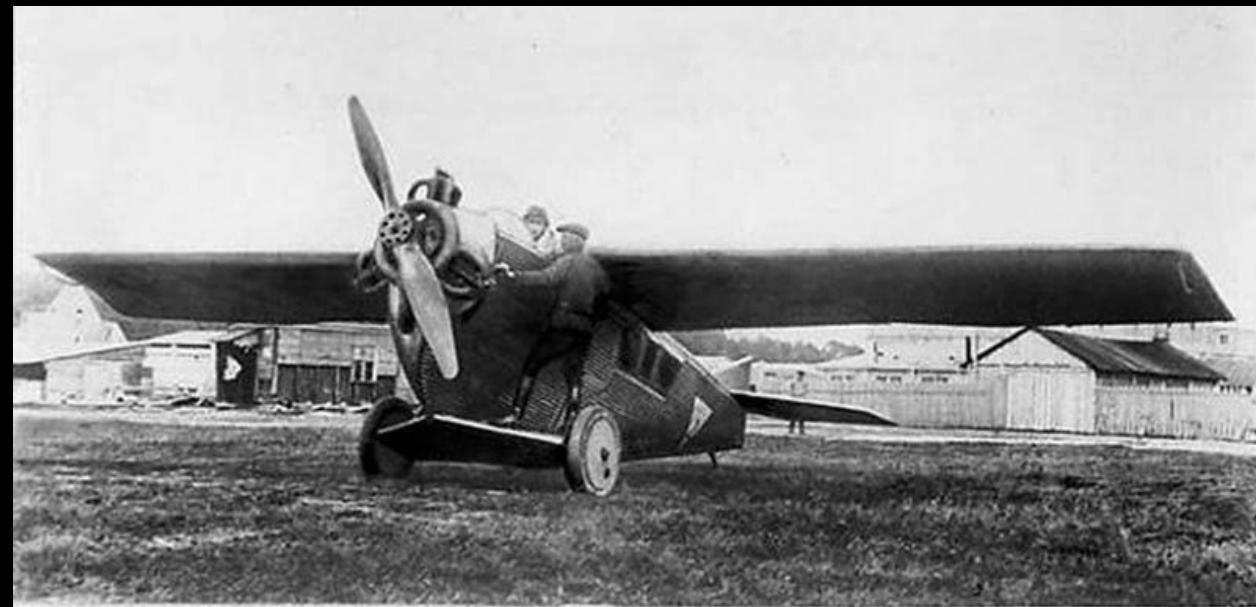
Успешные летные испытания первого цельнометаллического самолета АНТ-2.
