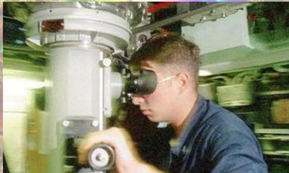
**С помощью перископа командир подводной лодки определяет направление (пеленг) с подводной лодки на цель, курсовой угол корабля противника, расстояние до цели, скорость ее, а также момент торпедного залпа.**
