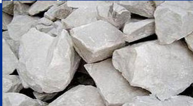
Гипс строительный - белый или сероватый порошок тонкого помола, получаемый из гипсового камня (природного гипса) путём обжига при температуре 140- 190 С;
