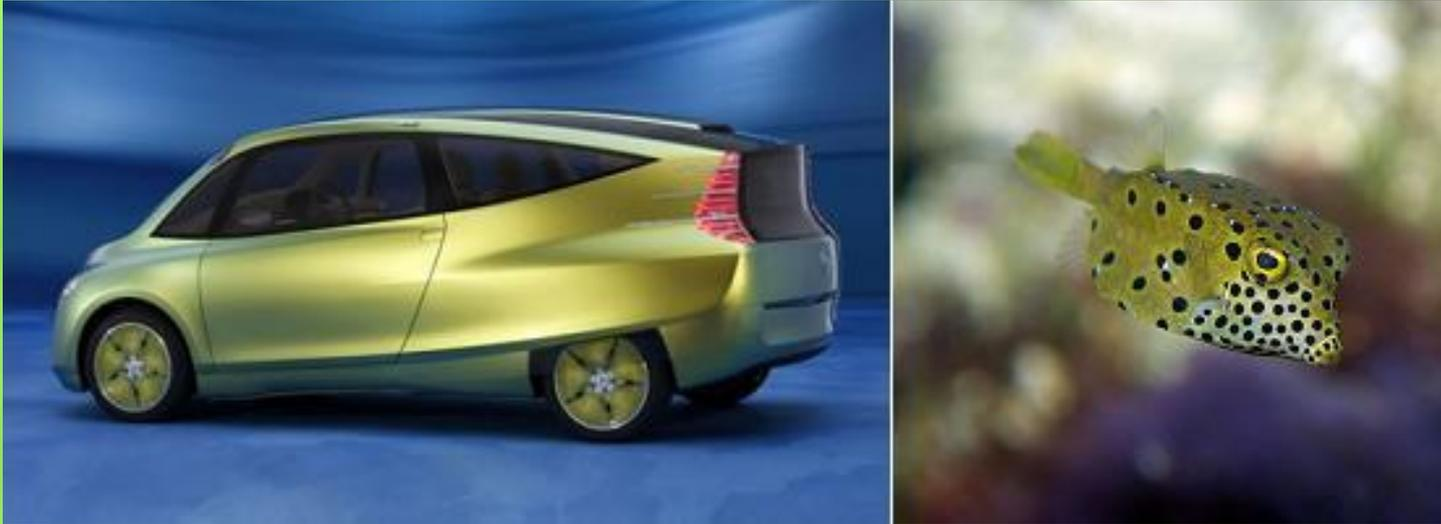
Корпорация Mercedes Benz разработала бионическое транспортное средство, скопированное с тропической рыбы-кузовка. Несмотря на свою чемоданообразную форму, машина имеет крайне низкое сопротивление воздуха.
