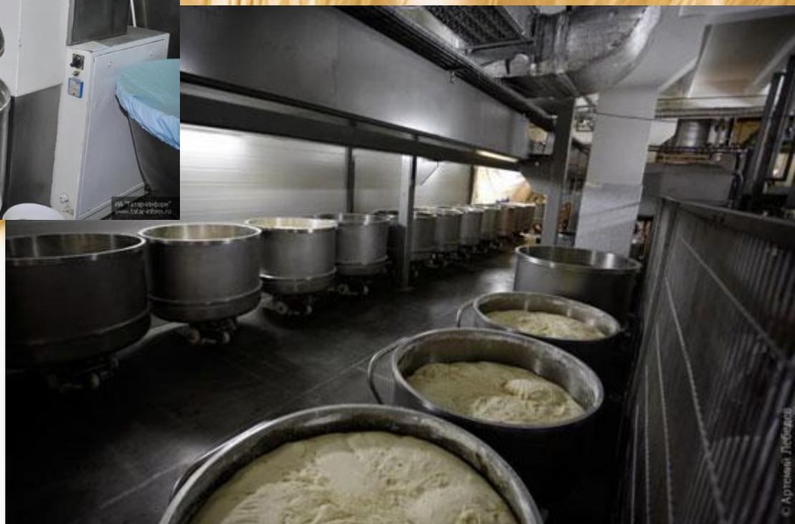
**КОГДА ТЕСТО «СОЗРЕВАЕТ», ДЁЖА ОПРОКИДЫВАЕТСЯ И ВЫВАЛИВАЕТ ТЕСТО В ВОРОНКУ НА ТЕСТОДЕЛИТЕЛЬ. ДЕЛИТЕЛЬНАЯ МАШИНА ДЕЛИТ ТЕСТО НА РАВНЫЕ КУСКИ, ЕСЛИ НУЖНО – УКЛАДЫВАЕТ ТЕСТО В КОРОБОЧКИ.**
