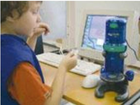
Оптический микроскоп, приспособленный для работы в школьных условиях. Снабжен преобразователем визуальной информации в цифровую, обеспечивающим передачу в компьютер в реальном времени изображения микрообъекта и микропроцесса, а также их хранения, в том числе в форме цифровой видеозаписи.
