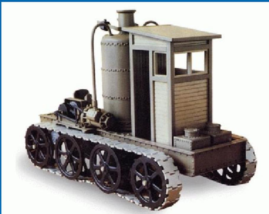
Посередине рамы длиной 5 метров стоял паровой котел с двумя паровыми машинами. Вращение от каждой машины через шестеренчатые передачи передавалось к ведущим колесам, находящимся в зацеплении со звеньями гусениц. Перед котлом размещалась будка и баки для воды и топлива.
