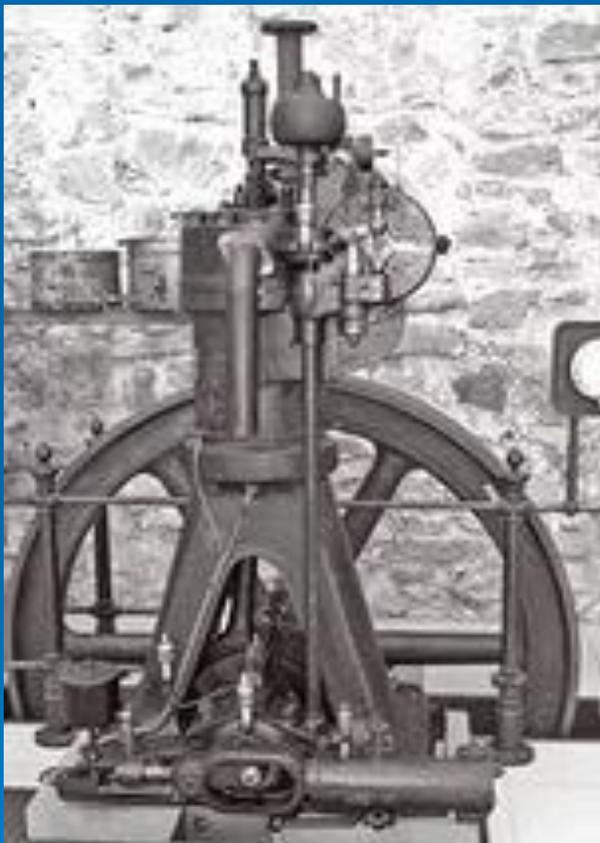
В 1897 г. на заводе в Аугсбурге был создан первый практический дизельный двигатель. Агрегат высотой в три метра развивал 172 об/мин и при диаметре единственного цилиндра 250 мм, ходе поршня 400 мм "выдавал" от 17,8 до 19,8 л.с., расходуя 258 г нефти на 1 л.с. в час. При этом термический КПД составлял 26,2% - вдвое выше, чем у паровой машины.
