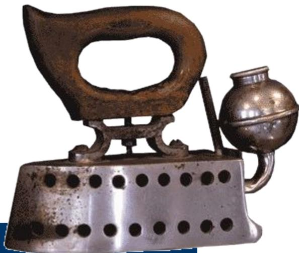
В XIX веке домохозяйки полюбили спиртовые утюги, которые были изобретены в Германии. К утюгу прикреплялась металлическая колбочка, в которую заливался спирт. При включении спирт по трубочкам поступал внутрь прибора и, сгорая, выделял необходимое количество тепла.
