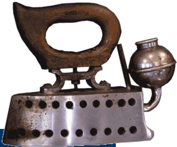
В XIX веке домохозяйки полюбили спиртовые утюги, которые были изобретены в Германии. К утюгу прикреплялась металлическая колбочка, в которую заливался спирт. При включении спирт по трубочкам поступал внутрь прибора и, сгорая, выделял необходимое количество тепла.
