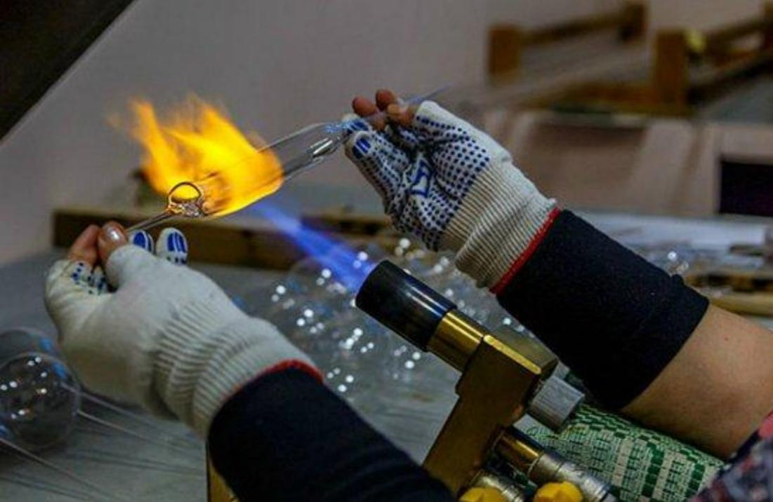
Затем этот вытянутый сплавленный кусочек стекла закручивается специальным крючком с одной стороны
