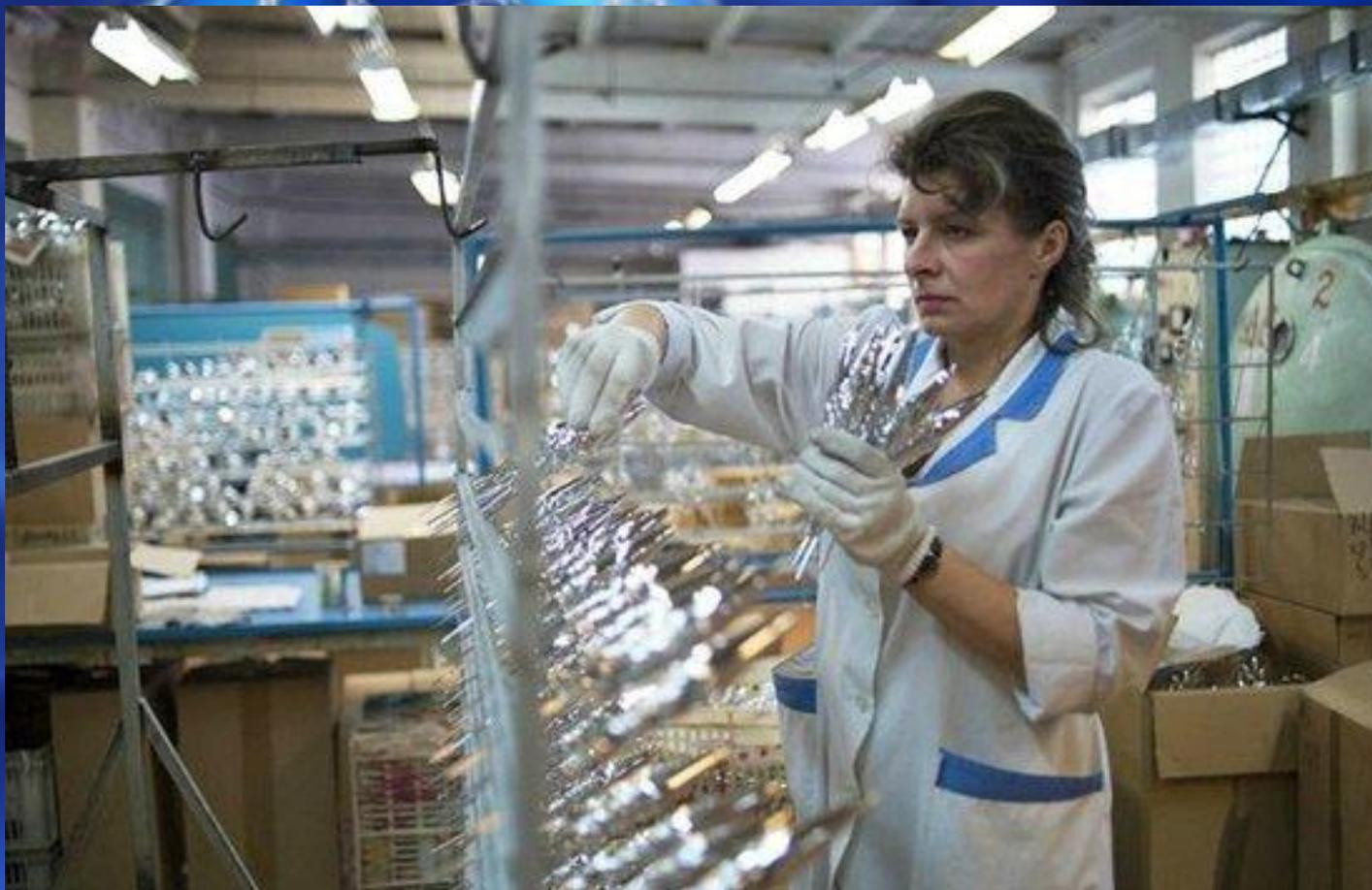
Этап серебрения : серебряный раствор застывает на стенках шарика, покрывая их тончайшим равномерным слоем. Процесс называется "реакцией серебряного зеркала".
