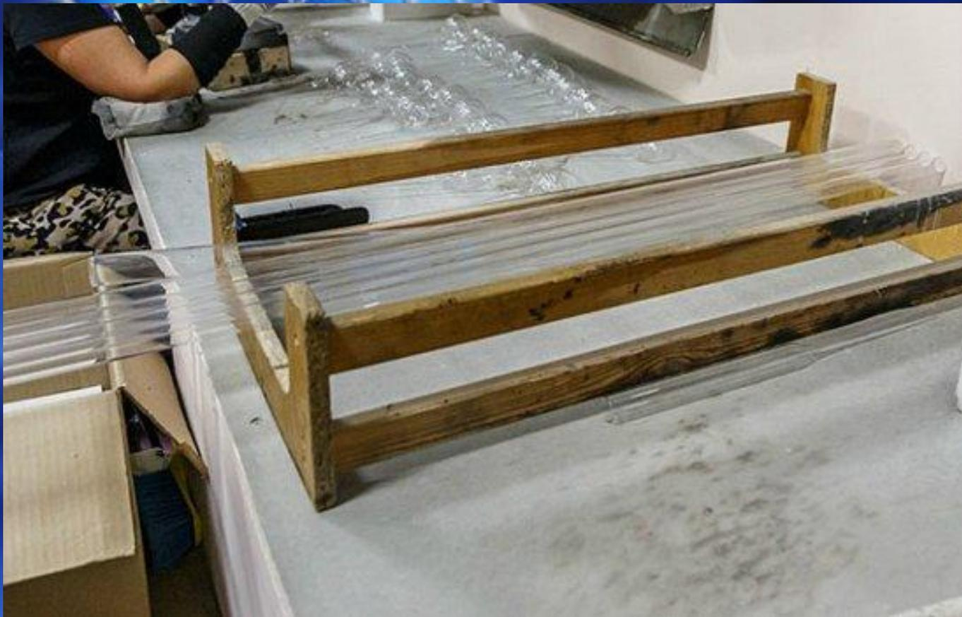
**Процесс изготовления елочных украшений начинается с выдувания. Для этого используется медицинское стекло. Мастера выдувают длинные полые стеклянные трубки.**
