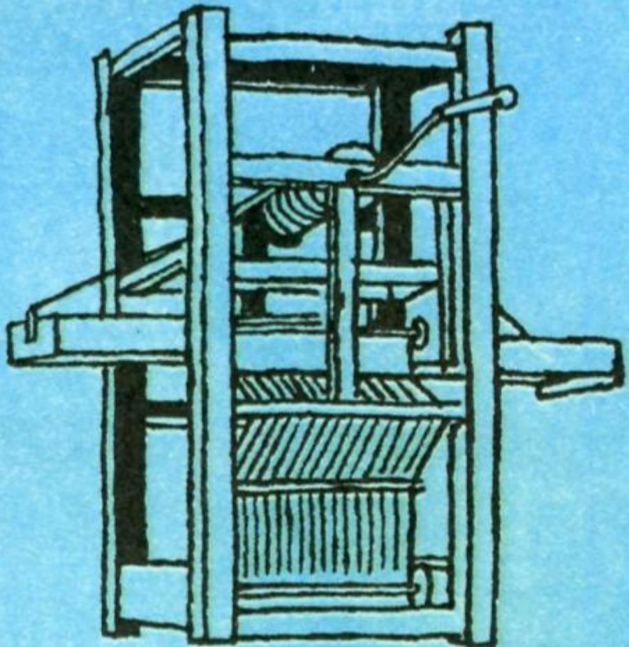
■ А этот механический ткацкий станок построил в 1785 году английский изобретатель Эдмунд Картрайт. Сначала его станок приводился в движение ножными педалями, но спустя четыре года Картрайт приспособил для этой цели паровую машину.
