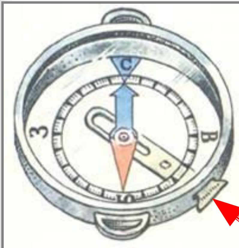
Поверните компас так, чтобы **синий конец стрелки** закончил работу, совпал с буквой **С**, поставьте стрелку (север), а **красный** – на предохранитель, с буквой **Ю** (юг); тогда все буквы укажут направление сторон горизонта.
