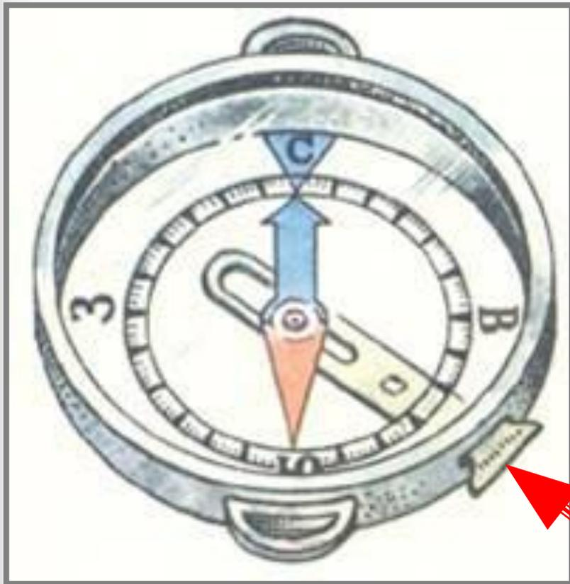
Поверните компас так, чтобы **синий** конец стрелки закончив работу совпал с буквой **С** (север), а **красный** — на предохранитель с буквой **Ю** (юг); тогда все буквы укажут направление сторон горизонта.
