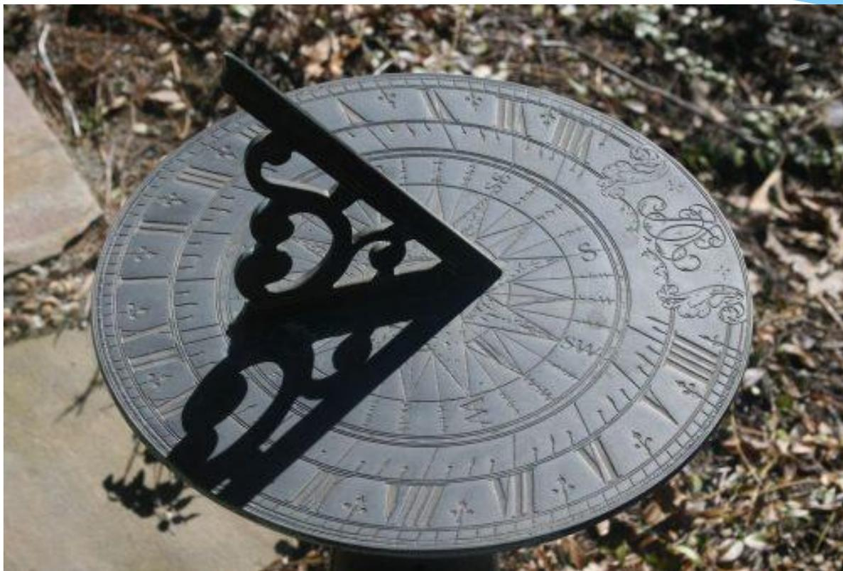
*Первым устройством, при помощи которых человек измерял время, были солнечные часы. Родина солнечных часов - Вавилон. Солнечные часы имели стержень и шкалу, похожую на циферблат часов. По мере того как солнце изменяло свое положение, от стержня падала тень на так называемый циферблат. Передвигаясь от стержня по шкале времени тень показывала который час.*
