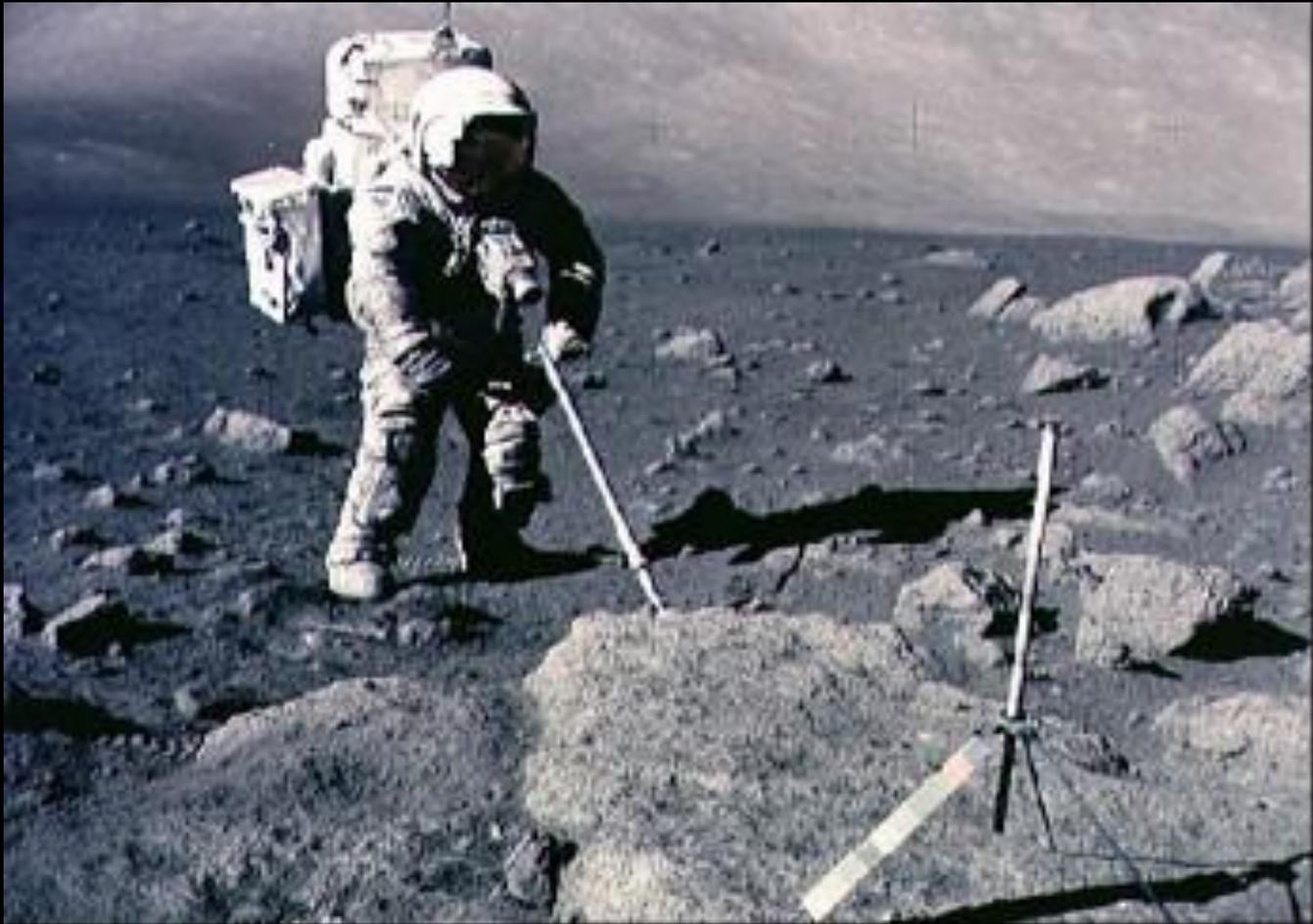
Гаррисон Шмидт, геолог, собирает образцы лунного грунта с помощью регулируемого совка. Устройство на скале на переднем плане обеспечивает устойчивую вертикаль.
