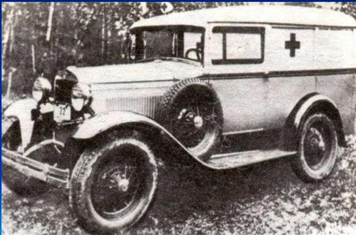
**Машина «Скорой помощи» на шасси ГАЗ-А. 1934 г.**
