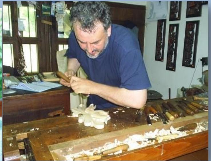
**Художественная резьба - один из древнейших и наиболее распространенных видов художественной обработки дерева, при котором узор наносится на изделие при помощи топора, ножа, резцов, долот, стамесок и других подобных инструментов.**
