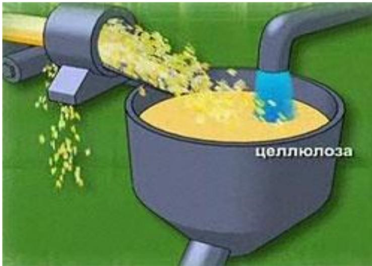
Очищенную и разваренную древесину фильтруют и промывают, чтобы очистить от примесей.
