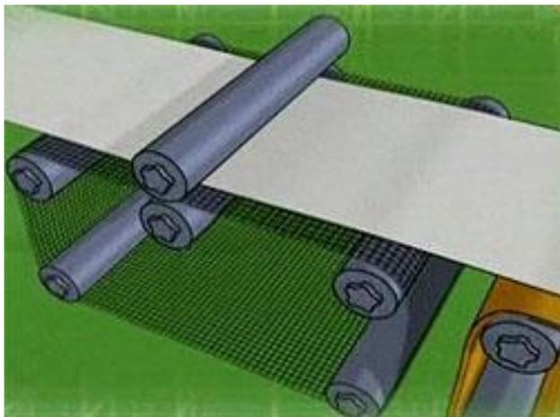
На ленточном конвейере часть воды вытекает через отверстия, и бумажные волокна начинают сплетаться друг с другом. Получается рулонная лента.
