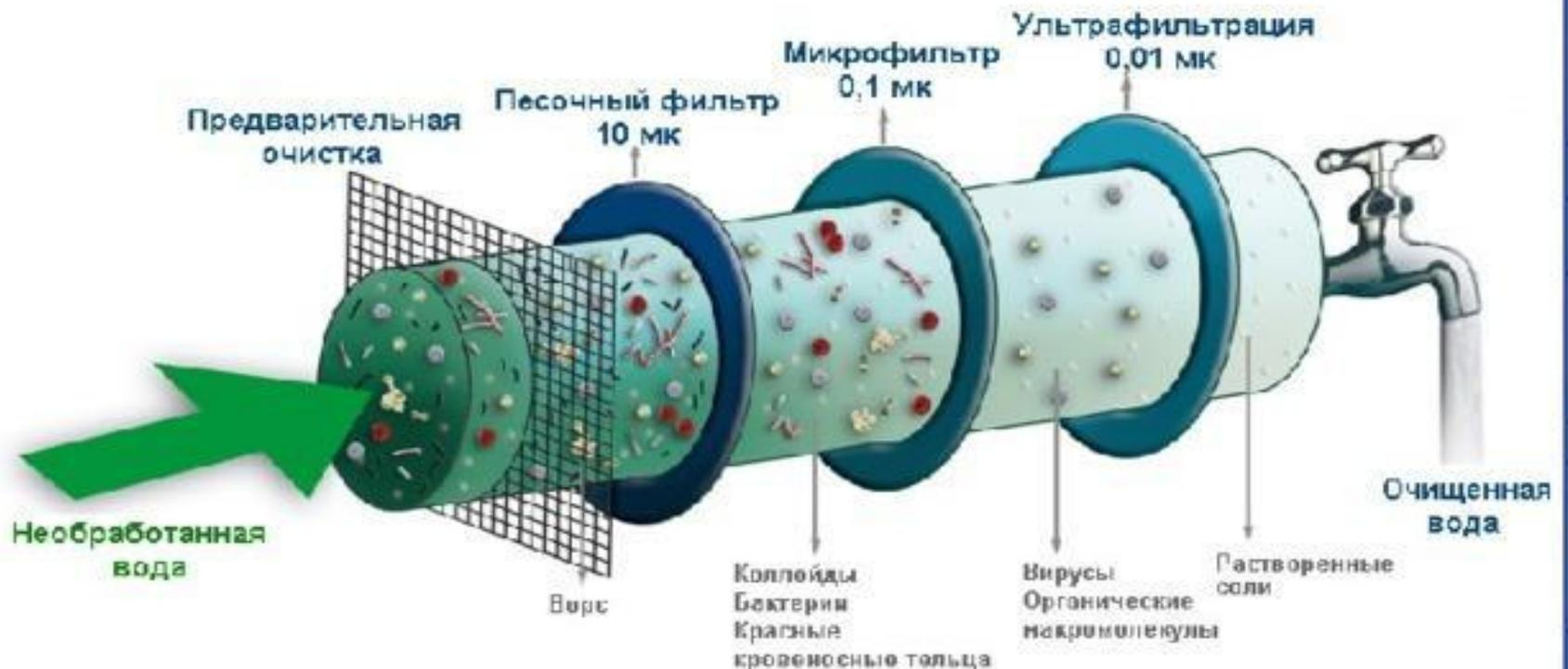
Потом вода попадает в водопровод, чтобы стать чистой она проходит через специальные фильтры.
