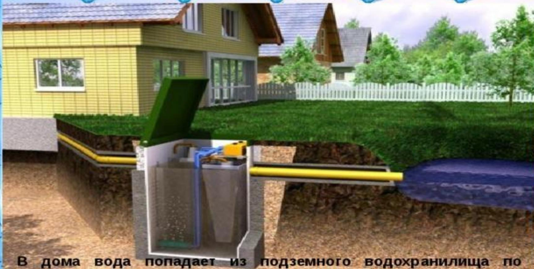
В дома вода попадает из подземного водохранилища по специальным трубам. Эти трубы называются водопроводными.
