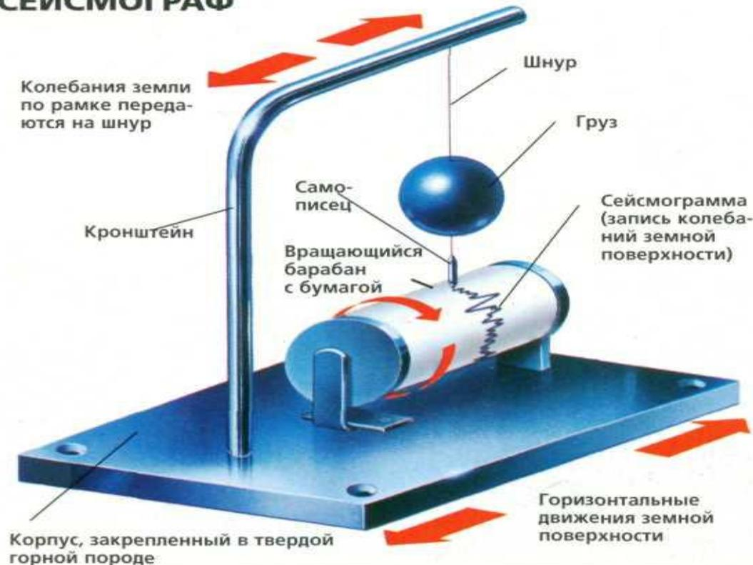
Сейсмограф регистрирует сейсмические волны. Груз подвешен на шнуре над механически вращаемым барабаном. Корпус прибора устанавливается на поверхности коренной породы. Сейсмические Р-волны приближающегося землетрясения производят колебания в горизонтальной плоскости и приводят рамку в движение. Самописец на маятнике повторяет эти движения, вычерчивая на вращающемся барабане кривую – сейсмограмму.
