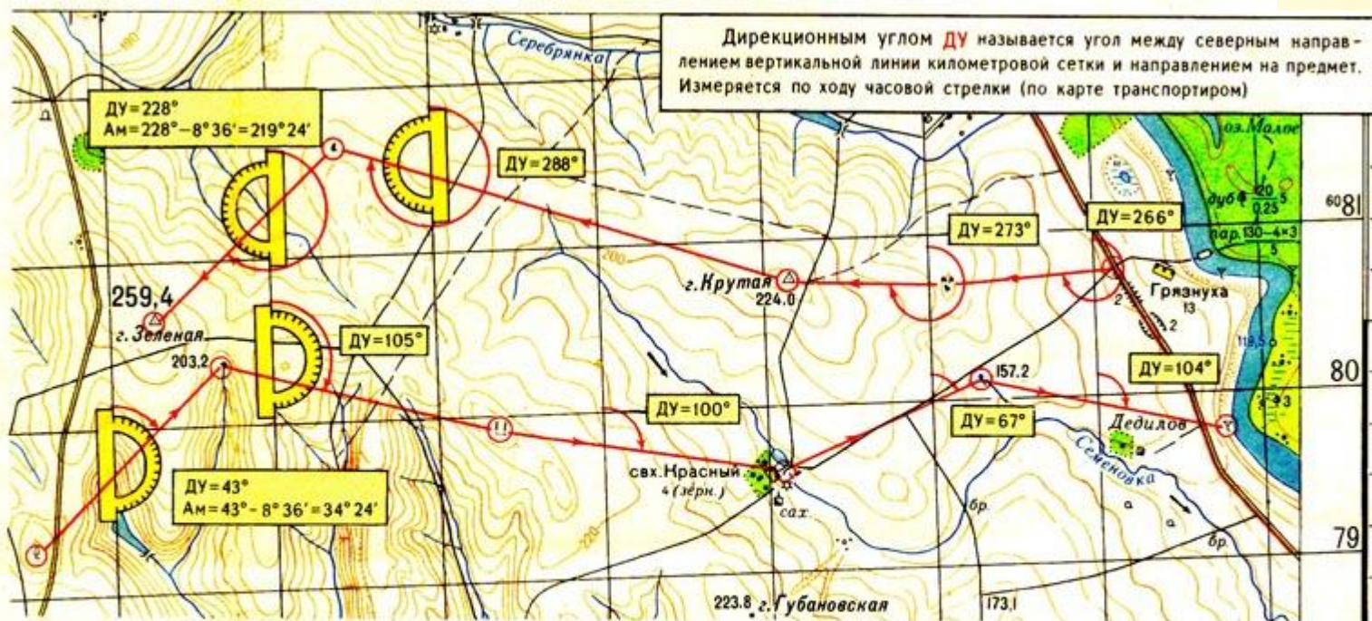
Определение магнитных азимутов по измеренным дирекционным углам
