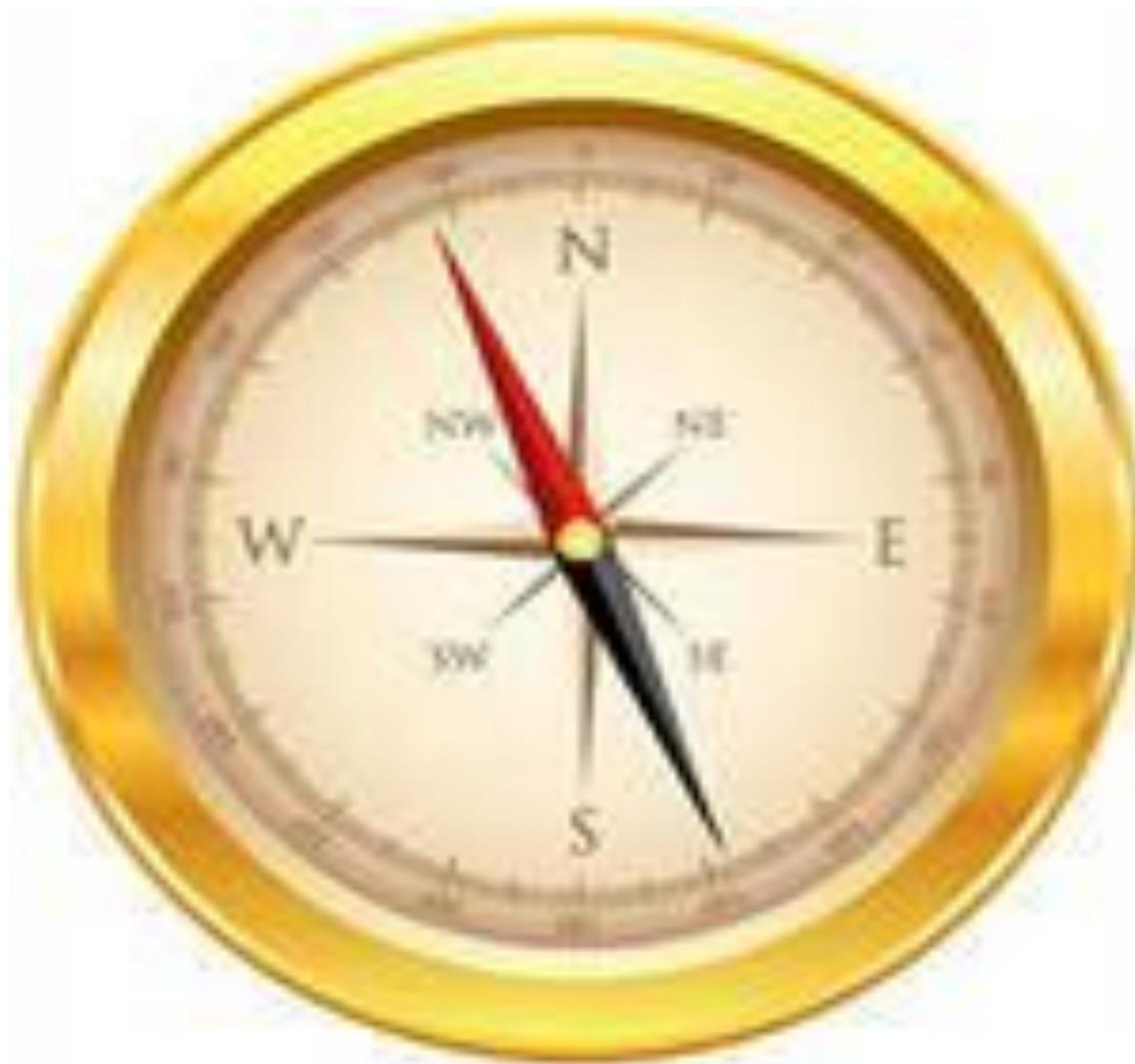
*Компас-прибор для определения сторон горизонта.*
