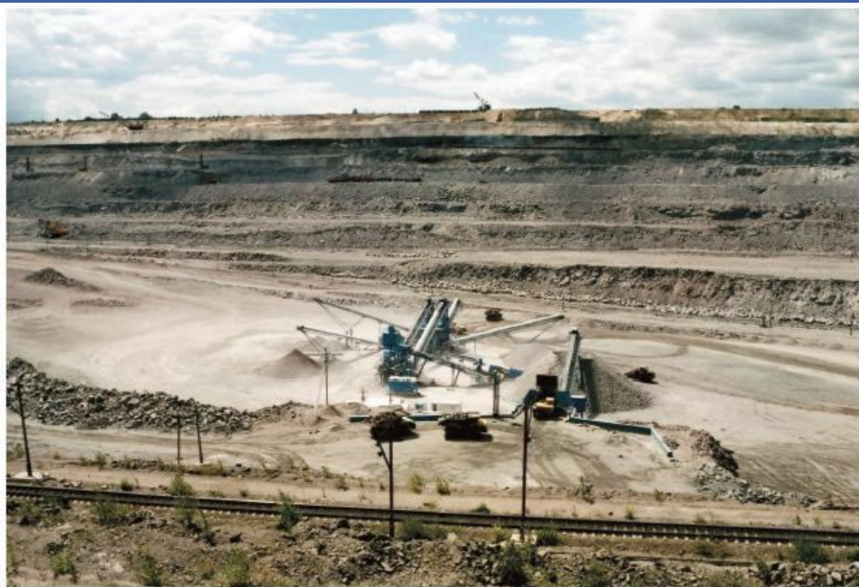
Рабочая зона современного карьера ОАО «Павловскгранит»: на переднем плане — внутрикарьерная передвижная ДСУ по производству фракционированного щебня из скальной вскрыши, 2006 г.
