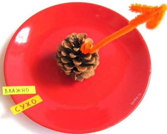
**Гигрометр** – прибор для определения влажности воздуха. Им служит подвешенная сосновая шишка. Если воздух сухой – она раскрывается, если влажный – закрывается.
