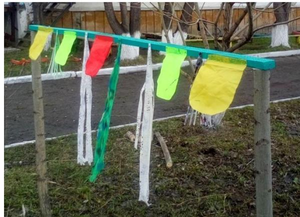
**Султанчики, вертушки-** приборы для определения направления и силы ветра
