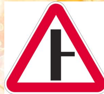
Примыкание второстепенной дороги
