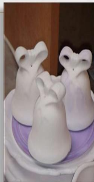
Готовые изделия сушат и обжигают в печи
