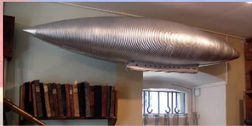
Модель оболочки аэростата из гофрированного металла
