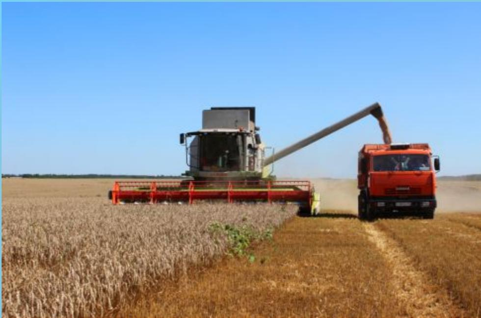
И тут на помощь людям приходят специальные зерноуборочные машины – комбайны. Они срезают растения пшеницы, отделяют колоски от стеблей. Стебельки уплотняются и выгружаются на поле, а зерно высыпается в кузов машины.
