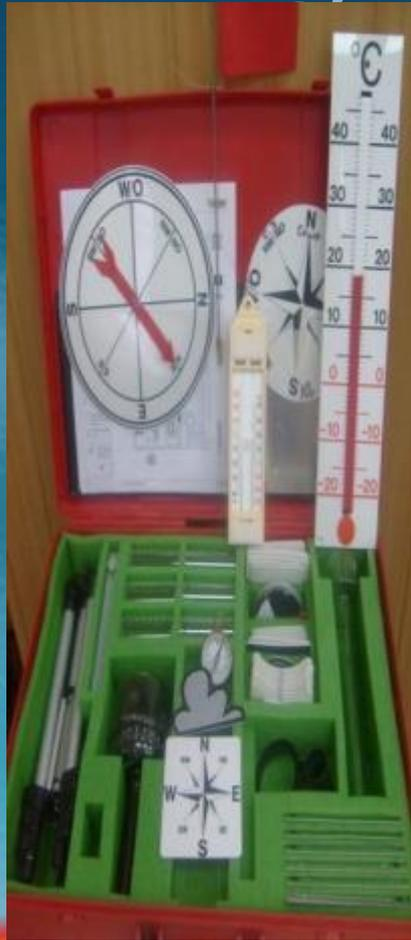
представляет собой набор приборов и инструментов в чемодане. Помогает систематизировать знания учащихся о понятии «погода» и изучить четыре её составляющие – температуру, облачность, осадки, силу ветра; с помощью простейших лабораторных приборов можно освоить способы наблюдения, измерения и регистрации различных погодных характеристик.
