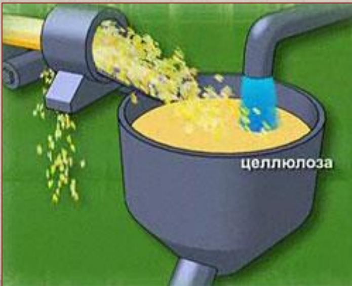
В этом случае щепки сортируют по размеру на специальных ситах и отправляют в варку. Варят дерево в специальных машинах, куда добавляют кислоту.
